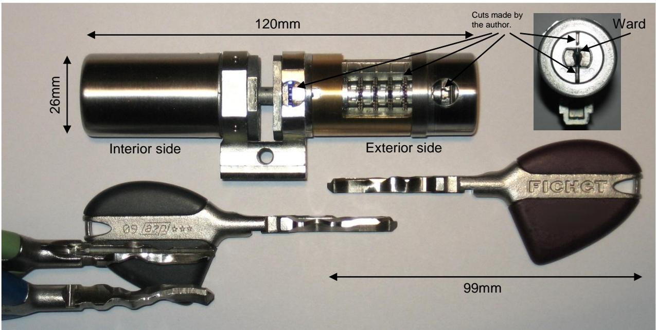
Fig. 4: The Fichet F3D monobloc cylinder with keys.
