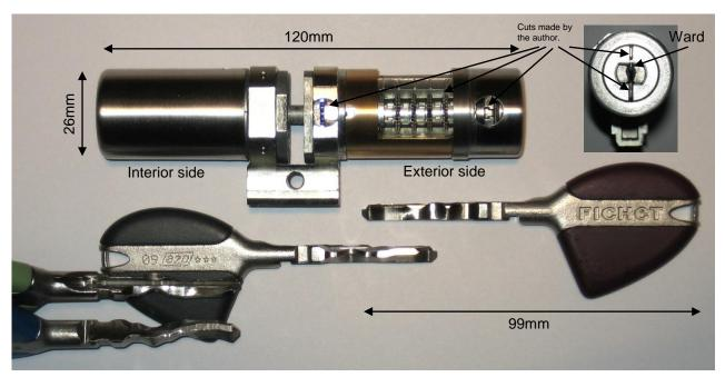
Fig. 4: The Fichet F3D monobloc cylinder with keys.
